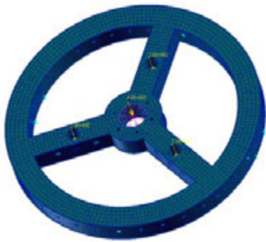
图9 主镜室的有限元模型
